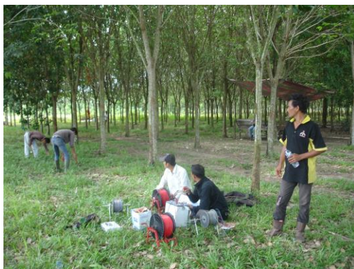
Gambar 2 Pengukuran VES.3 di Mess
