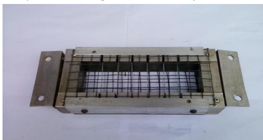
Gambar 2 Periphyton Sampler (Modifikasi APHA-AWWA-WEF, 2012)
