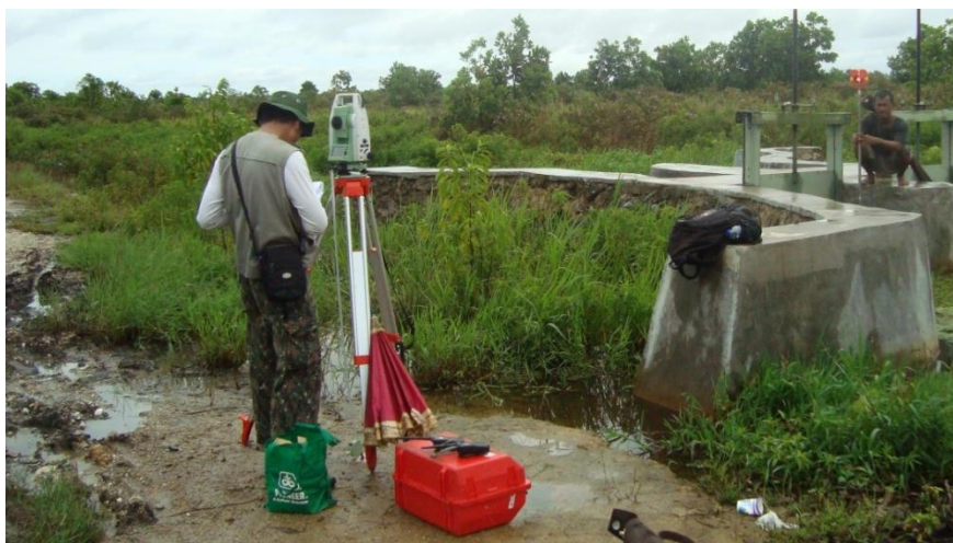
Gambar 2 Alat Total Station (TS) untuk mengukur beda tinggi antara dua titik
